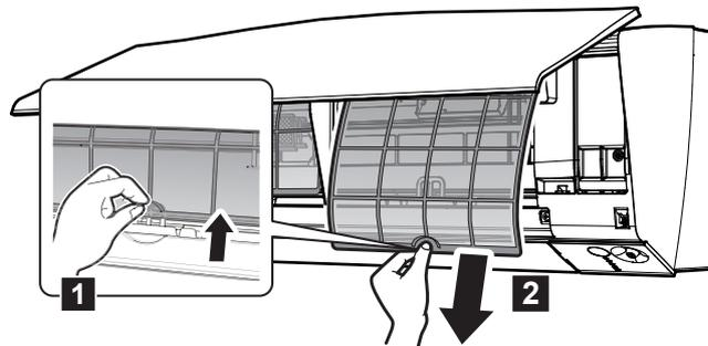
**Klasse 40:** Der Titan-Apatit-Desodorier-Filter und der Silberpartikelfilter (Ag-Ion-Filter) MÜSSEN entfernt werden, bevor der Luftfilter gereinigt werden kann.
