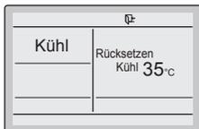
Das Rücksetz-Symbol "🏠+" blinkt, wenn das Gerät unter der Rücksetzfunktion eingeschaltet wird.
